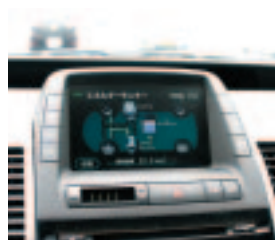
エネルギーモニター画面。運転中のエネルギーの流れもリアルタイムで表示される
