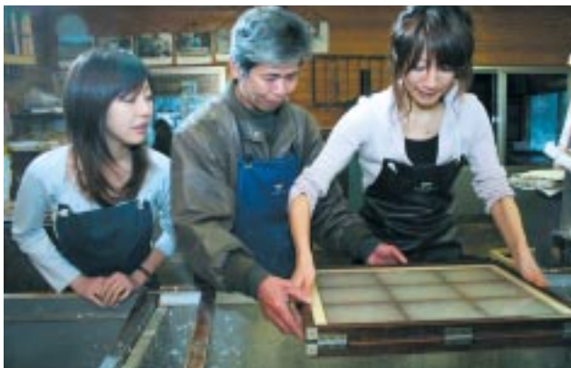
ミツマタの皮を乾燥させ、ネリ材を加えた液の中をすけたですく。ハガキは一度で9枚作ることができる
